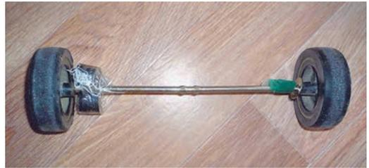
оси закреплен дополнительный груз. В этом случае колеса катятся по разным окружностям. Тяжелое колесо – по малой окружности, легкое колесо – по большой. Радиусы этих окружностей обратно пропорциональны массам колес. Если одно колесо сделать очень тяжелым, то оно вращаться практически не будет и его траектория на полу превратится в точку. Нам будет казаться, что легкое колесо вращается вокруг тяжелого.
